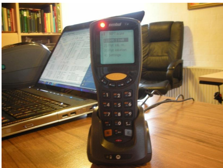
Figur 2 Symbol strekkode skanner med menu for skanning af lokale id og inventar id
